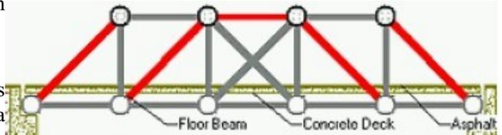
Pour assurer la sécurité du pont, il faut renforcer la solidité des profilés utilisés. Pour la renforcer, la solution la plus simple est de modifier leur dimension. Tout d'abord, utilisez l'**outil Sélection (Select a joint of member)** pour sélectionner l'une des liaisons fautives en cliquant dessus.
